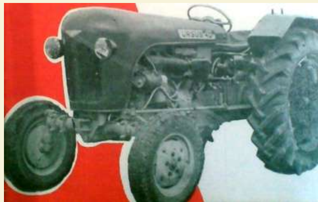
Prototypowy URSUS C-340, posiadający trzy cylindrowy silnik o mocy 40 KM
